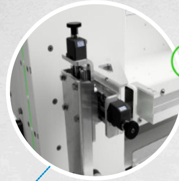
Brenner-Support mit Zählwerk in Kombination mit Touch & Signal Softwarefunktion macht die Brenneinstellung 100% zuverlässig und einfach
