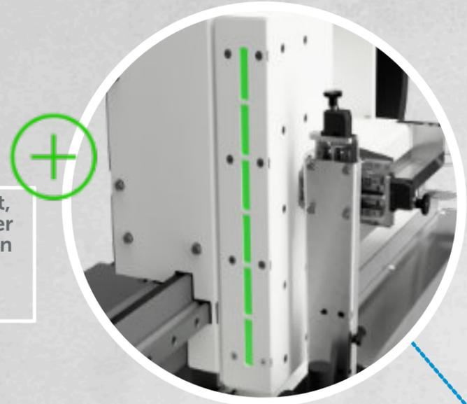
Maschinenleuchte - High performance LED mit 10W, befestigt am Brennerfahrwerk
