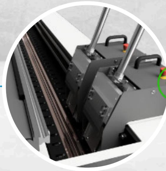
Hochpräziser Mittelanschlag und Vorspannfunktion, für schnelles und komfortables Einlegen der Teile
