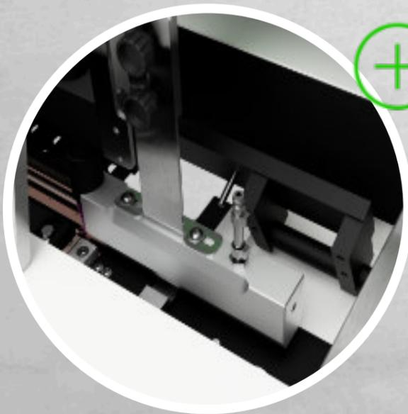
Speziell entwickeltes Holmkonzept mit schnell wechselbarer Unterlagschiene und Kontakt-Kühlleitung
