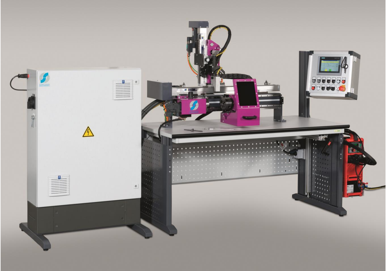
Abbildung 1: ROTAWELD D0200-L0500-HW032 mit 2 Brenner-Servoachsen (Sonderausführung).
