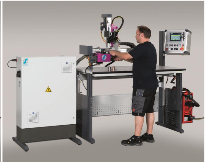
Abbildung 8: Ergonomischer Arbeitsplatz mit manueller Höhenverstellung (optional)
