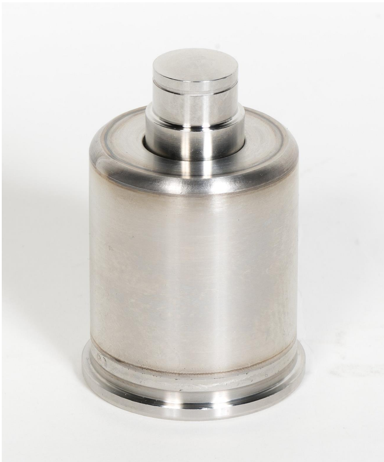
Abbildung 12: Musterteil mit 2 Schweißnähten, Ø 40 mm, hochlegierter Edelstahl
