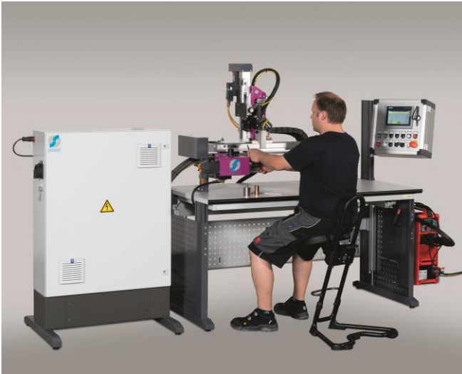
Abbildung 8: Ergonomischer Arbeitsplatz mit manueller Höhenverstellung (optional)
