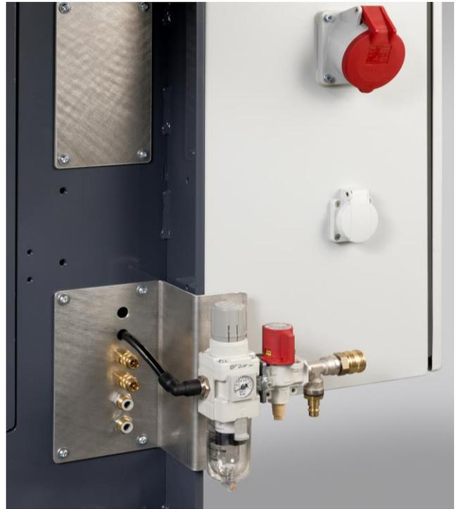
Abb. 3: LOTO Anschlüsse, Druckluft, Kühlwasser, Schweißgase und elektrischer Anschluss
