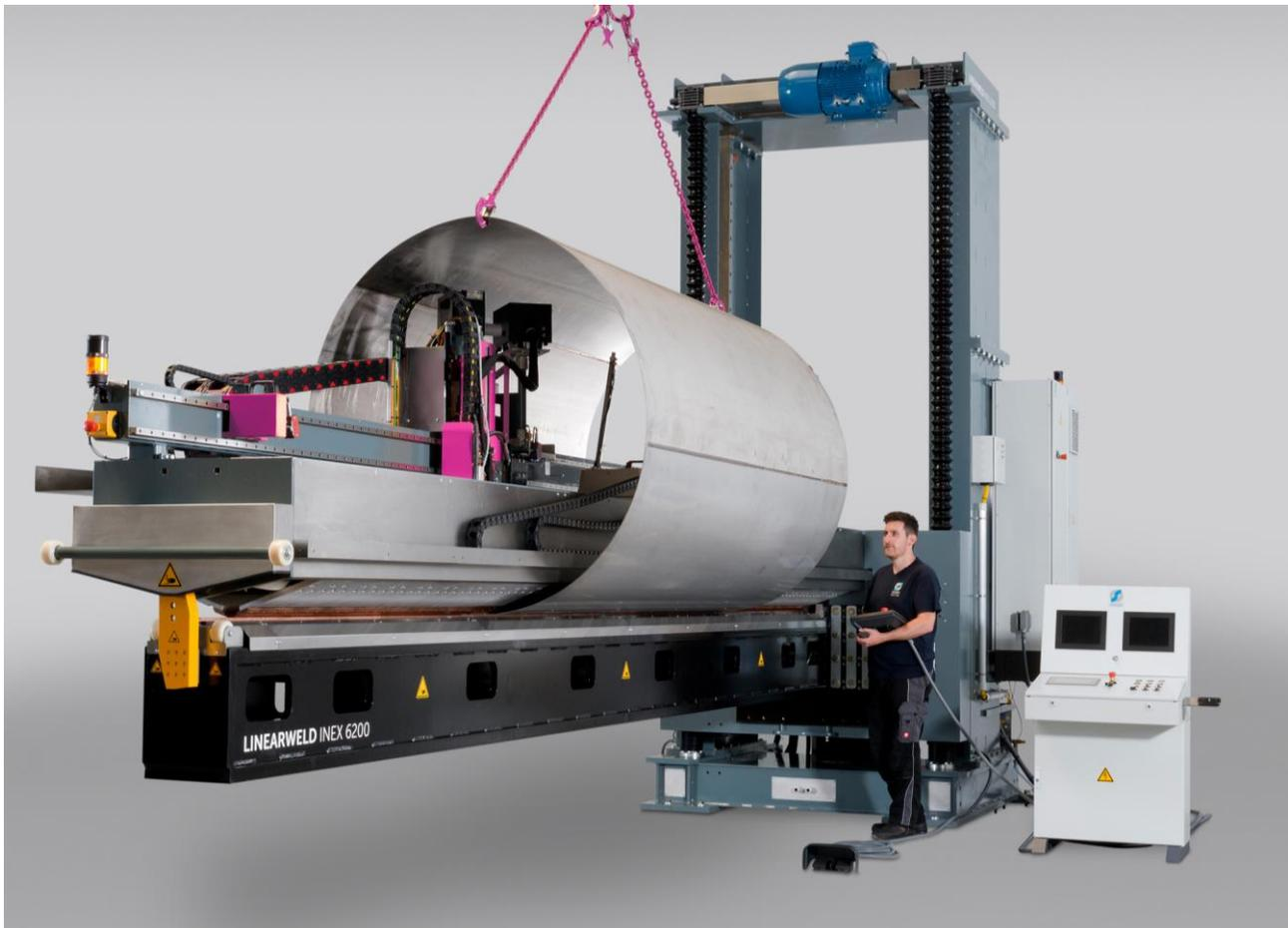
Abb. 5: LINEARWELD INEX 6200 mit elektromotorischer Höhenverstellung, Rohr und Bediener
