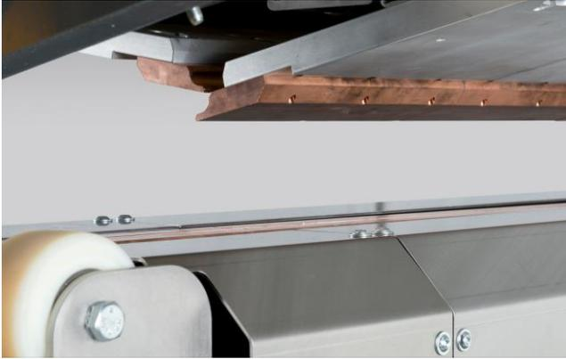
Abb. 12: Schienenhub Spannsystem, unten
