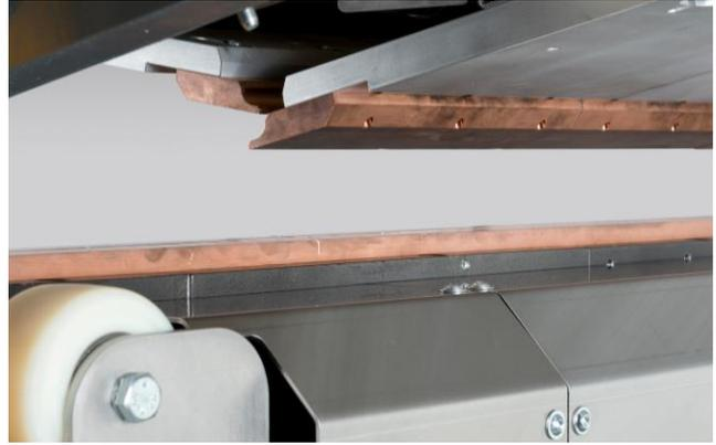
Abb. 13: Schienenhub Spannsystem, oben
