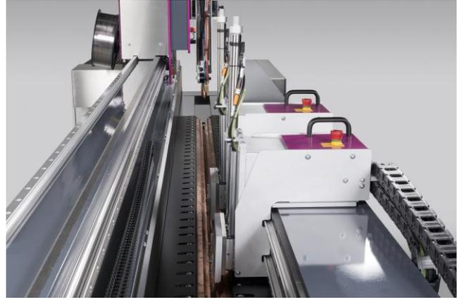
Abb. 19: Pneumatischer Mittenanschlag
