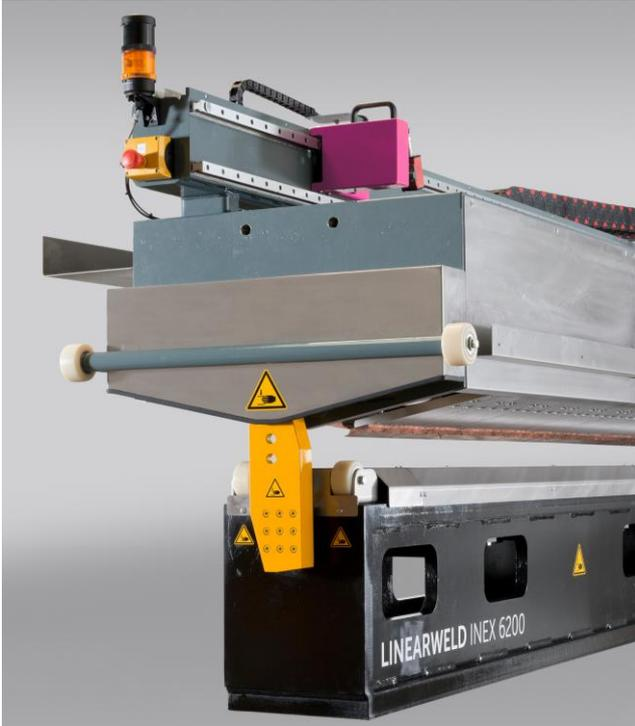
Abb. 2: Pneumatisches Holmschloss
