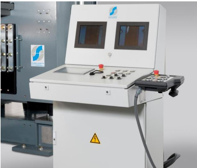
Abb. 14: Externes Bediengerät mit Fernbedienung
