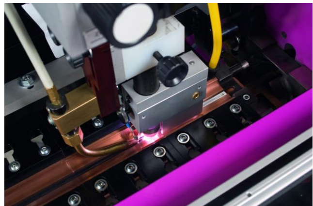
Abb. 18: Kaltdrahteinheit mit Führung
