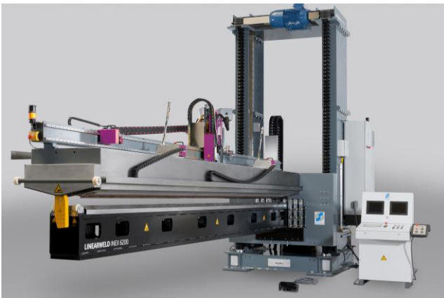
Abb. 21: Elektrische Höhenverstellung, Position unten
