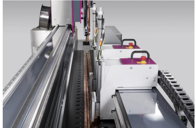
Abb. 20: Pneumatischer Mittenanschlag verfahrbar
