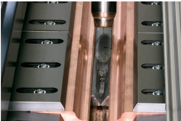
Abb. 30: MAG geschweißtes Blech mit WIG Wurzel, t = 10 mm
