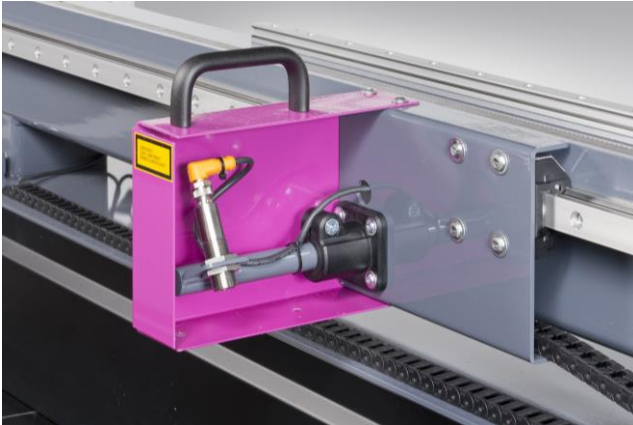
Abb. 19: Mittenmarkierung mit Laserpointer
