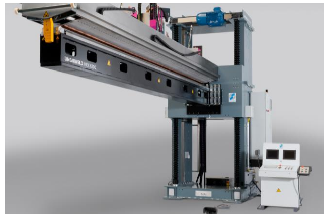
Abb. 22: Elektrische Höhenverstellung, Position oben
