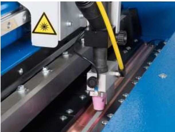
Abbildung 3: Spannsystem und WIG-Brenner mit Schleppgasdüse, Mittenanschlag links
