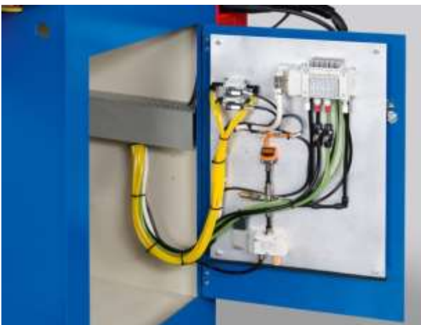
Abbildung 4: Einfach zugängliche Pneumatik-Ventilinsel
