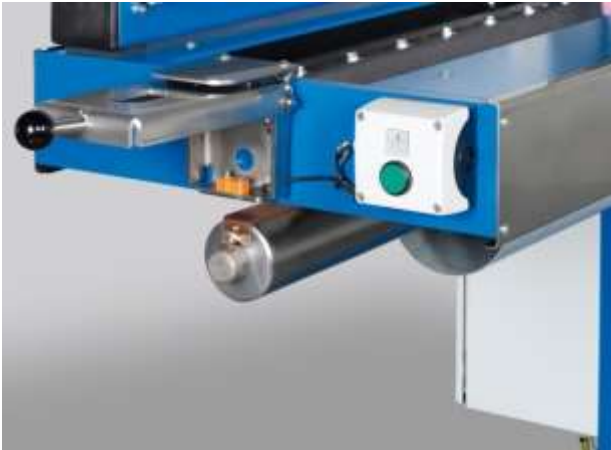
Abbildung 2: Manuelles Schloss geöffnet (einfache Bedienung, Endlage elektrisch überwacht)
