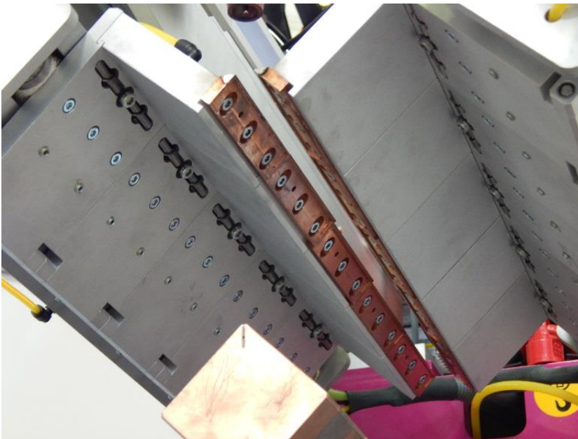
Abbildung 3: Flexibles Außenspannsystem für Aufkantungen bis zu 80 mm
