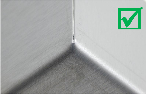
Abbildung 22: Biegeauge 1.4301 t = 1,0 mm
