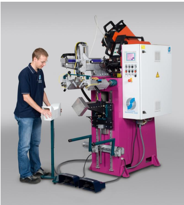
Abbildung 5: Holmhub unten, 2-Handbedienung
