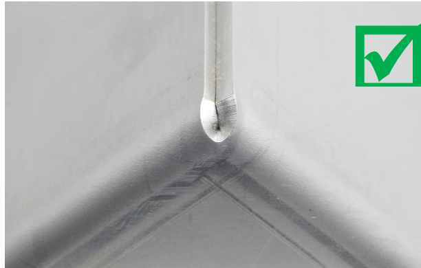
Abbildung 25: Biegeauge 1.4301 t = 2,5 mm
