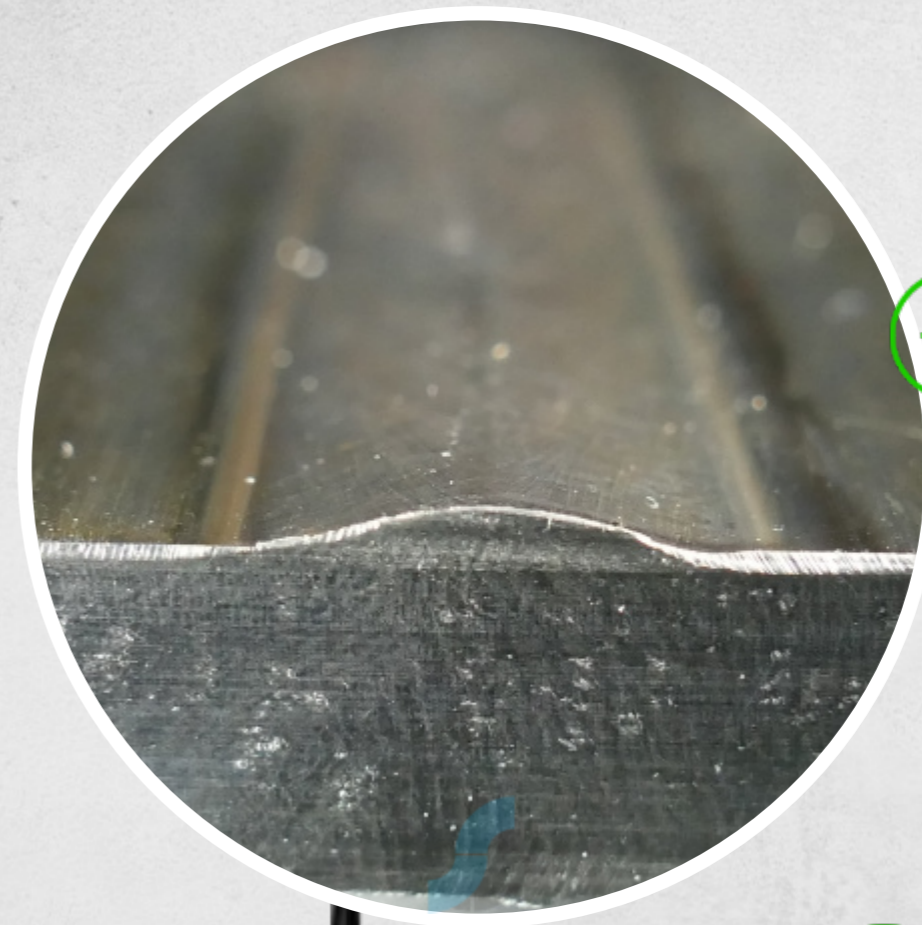
Edelstahl Behälter T: 10,0 mm Plasma Stichloch
