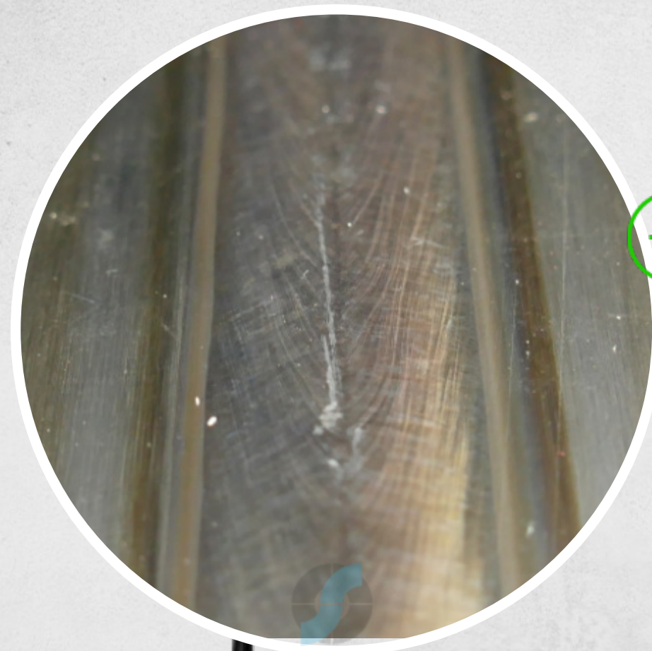
Edelstahl Behälter T: 10,0 mm PLASMA Stichloch
