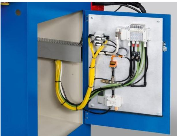
Abbildung 4: Einfach zugängliche Pneumatik-Ventilinsel
