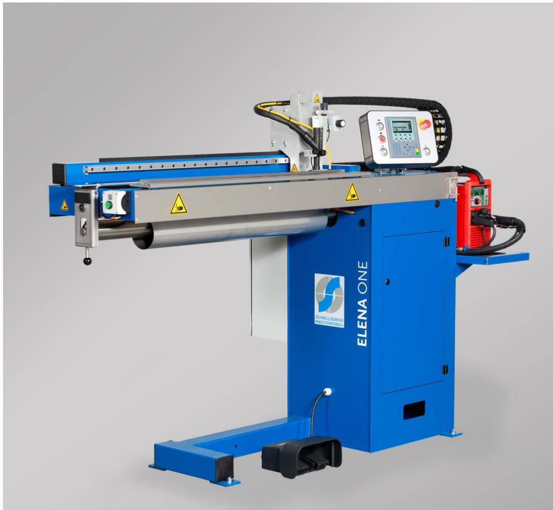
Abbildung 1: ELENA ONE mit optionaler Schweißstromquelle FRONIUS TT 2200 2/4 Takt
